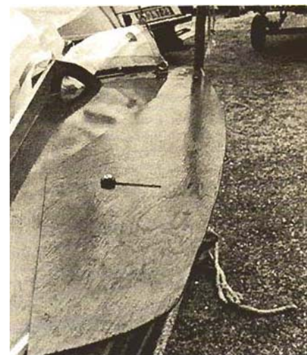
Déflecteur déployé : un axe à l'avant, une lumière à l'arrière, on peut le manoeuvrer d'une main.
