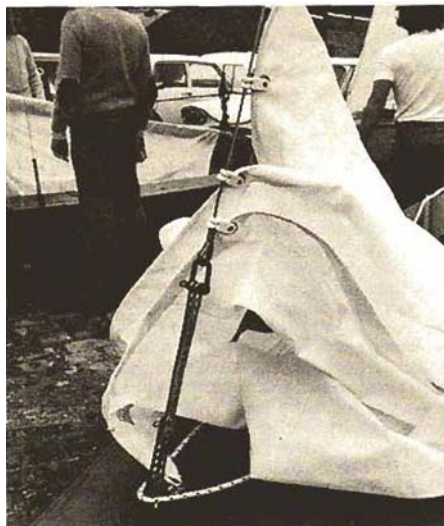
Boudins et écope, hale-bas luxueux (à poulies). Remarquer l'étambrai rapporté, les cales de mâts, les nœuds sur la balancine afin de régler la hauteur du tangon.
