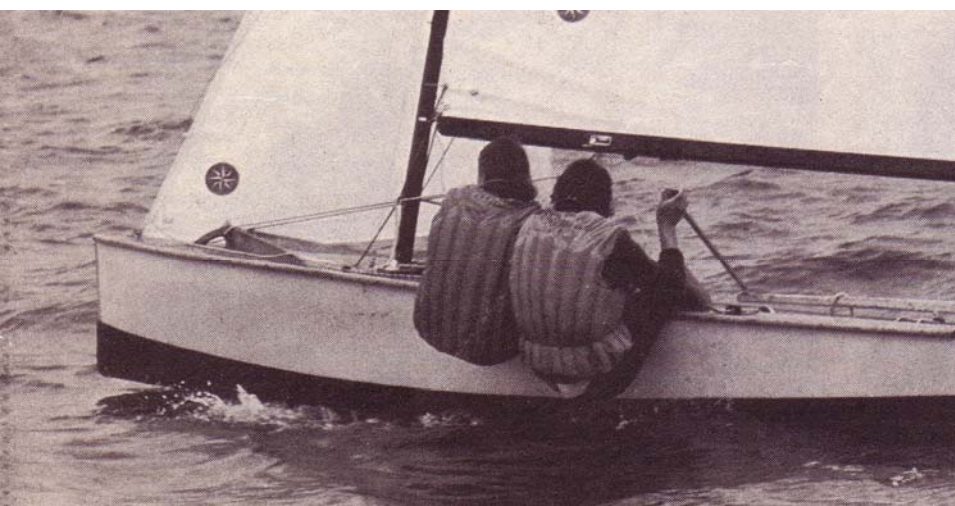
Les poids sont bien regroupés, l'étrave juste dégagée de la surface de l'eau. Faire passer le bout du cunningham devant le mat supprimerait le pli au point d'amure.
