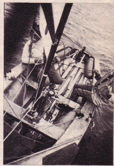
*L'étambrai, trop large, porte une plaque de contre-plaqué, avec des cales sur l'avant. La plupart des manœuvres reviennent au centre du banc, dessus ou dessous, comme le taquet de blocage du hale-bas.*
