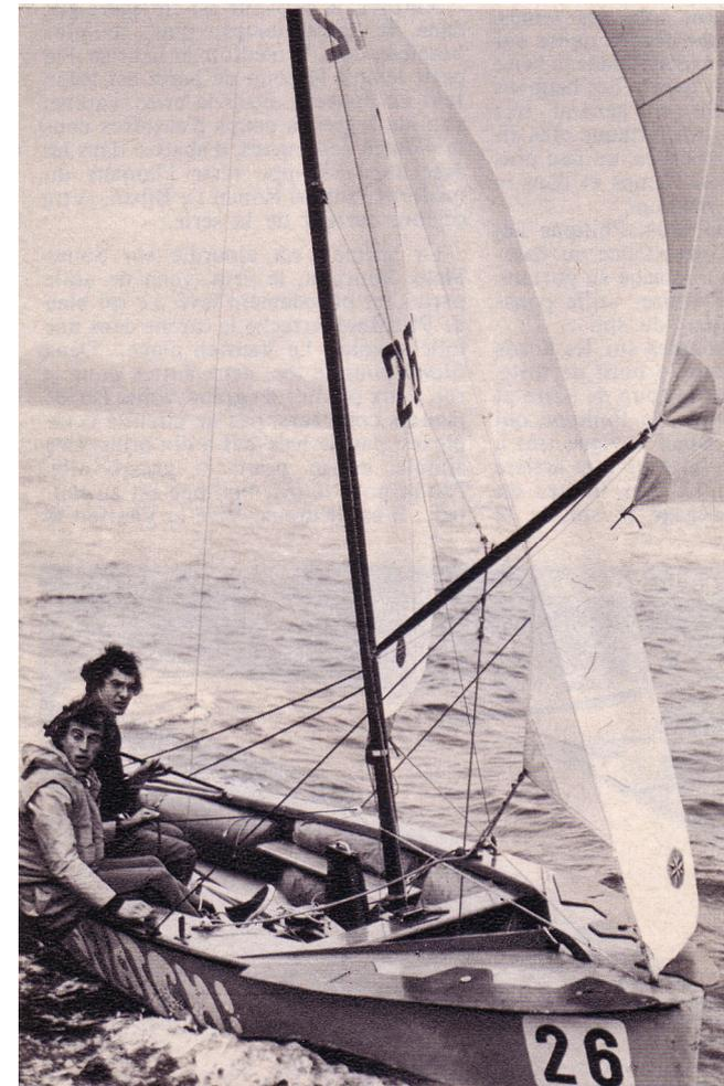
*Navigaison en contre-gite. La barre doit rester absolument neutre. La balancine est réglable. Le spi porte haut.*
