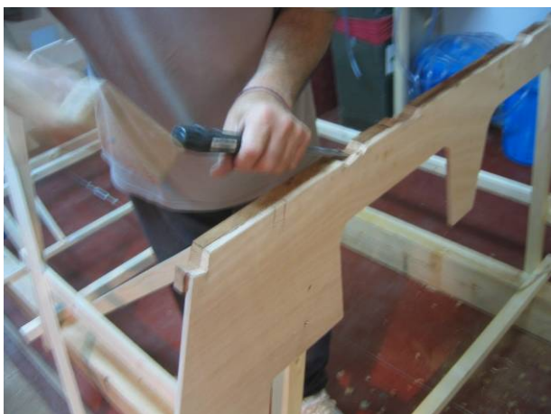
Vaciado de los recesos
