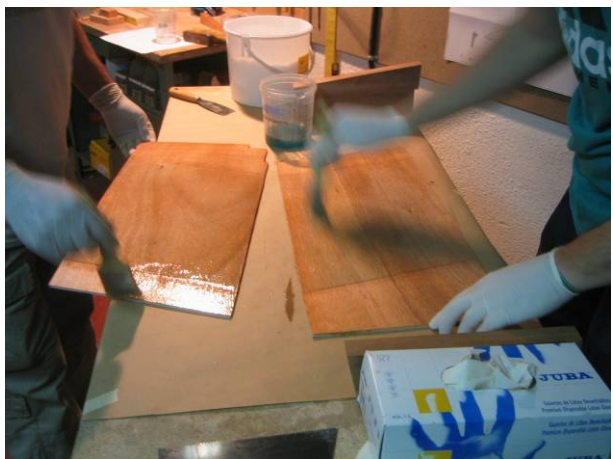
Impermeabilizando la caja de orza
