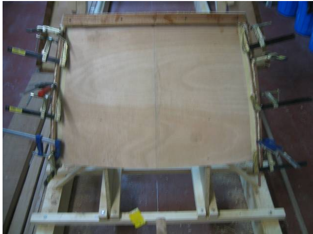
Encolado de listones soporte de forro
