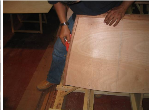
Realizando la curvatura longitudinal del mamparo
