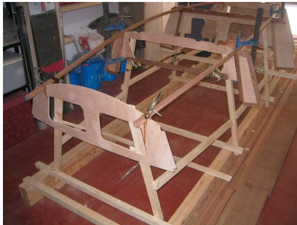
Colocación de listones interiores
