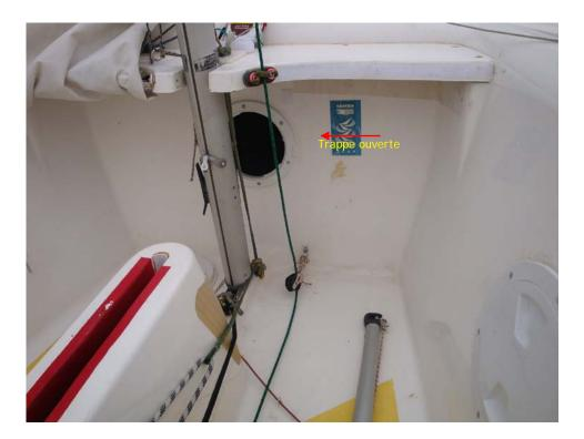
La trappe s'ouvre pour vérifier les caissons, et constater qu'il n'y a pas d'entrées d'eau. (Ce sont habituellement de petites infiltrations dues aux fixations) et pour pouvoir les assécher.
